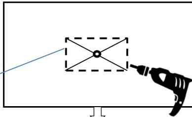
Placez la tige montée sur la paroi en verre. Aligner à l'aide d'un niveau à bulle sur la tige et un carré sur le mur (voir aussi l'étape 1). Marquez le porte-canne sur le mur avec un et dessinez le point central sur celui-ci. Percez le trou pour la cheville murale dans le mur.
