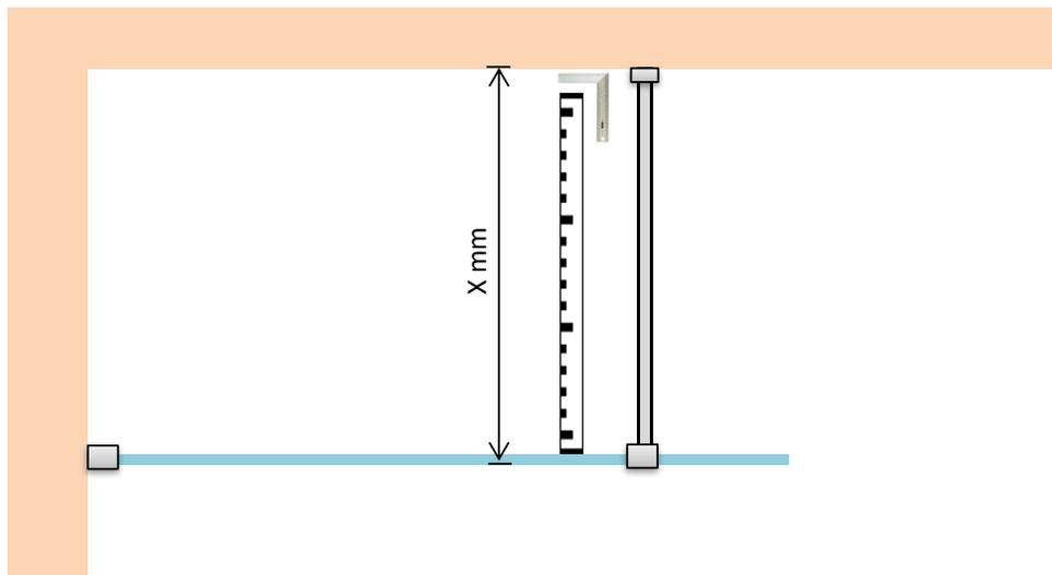
Vérifiez d'abord à l'aide d'un niveau à bulle que la paroi en verre est de niveau avec le sol et parallèle au mur.
