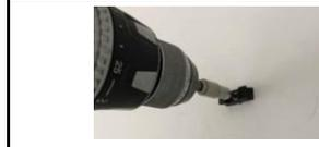
Montez le bloc de fixation du porte-canne sur le mur à l'aide d'un tournevis ou d'une visseuse à piles.
